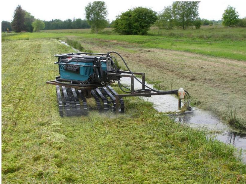
**Bild 4: Das Oberteil der Raupe ist drehbar. Am Ende der Fläche muss sie nicht wenden, sondern lediglich das Oberteil um 180 Grad drehen. Ein Vorgewende ist somit nicht erforderlich und die Arbeitsgeschwindigkeit erhöht sich.**
